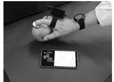
柿の食感を測定するウェアラブル型装置
